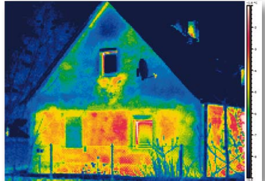
Aufnahme mit einer geometrischen Auflösung von 200x150 Pixel und einer thermischen Empfindlichkeit von <70\text{ mK} .
