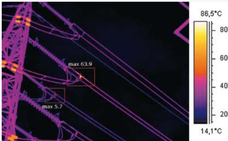
Aufnahme mit einer geometrischen Auflösung von 640x480 Pixel und einer thermischen Empfindlichkeit von <45 mK. Beachten Sie, wie die heiße Stelle jetzt deutlich sichtbar ist und aufgrund der höheren Pixelanzahl ein noch genauere Temperaturmesswert der Problemstelle erzielt wird. Es ist jetzt klar, dass bei der Stromleitung ein Problem vorliegt.
