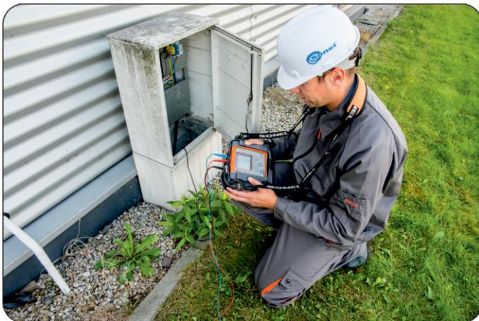
Störspannungsmessung  $U_N$  (RMS)
