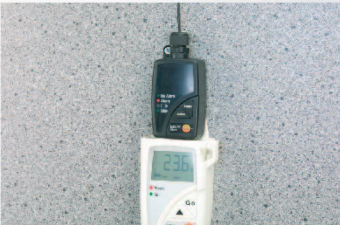
Alarm-Schaltausgang für die zuverlässige Weiterleitung von Grenzwertüberschreitungen
