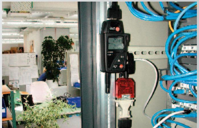
Auslesen der im Logger gespeicherten Messdaten über das PC-Netzwerk mit dem Ethernet-Adapter
