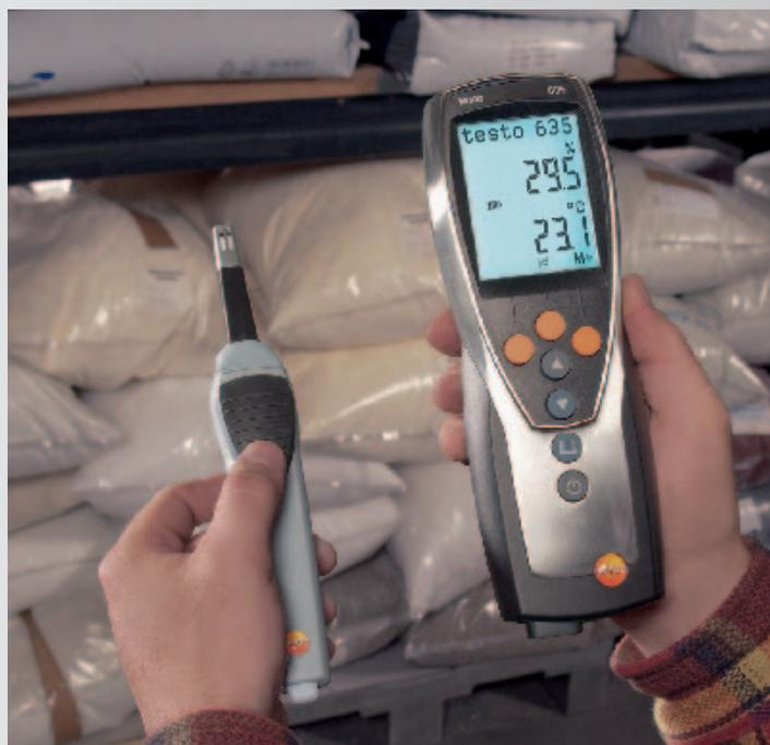
Kabellose Messung von Lagertemperatur und -feuchte mit dem Funkhandgriff und steckbarem Feuchte-Fühlerkopf
