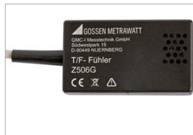
Adapter zur Messung von Temperatur und Feuchte mit Magnethalterung.
