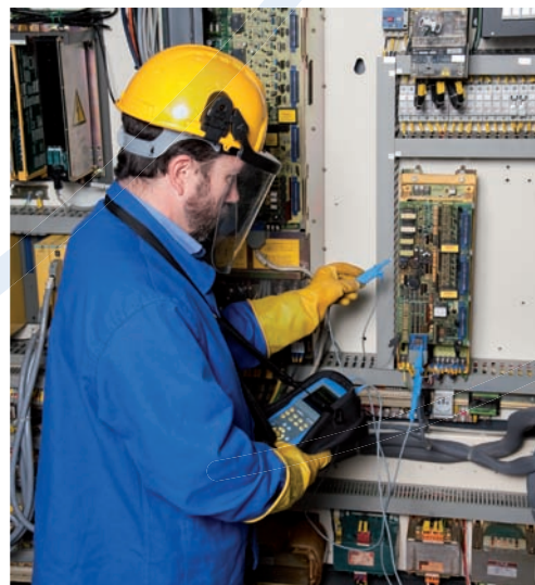
Funktionsprüfung an der elektronischen Steuerung einer Werkzeugmaschine
