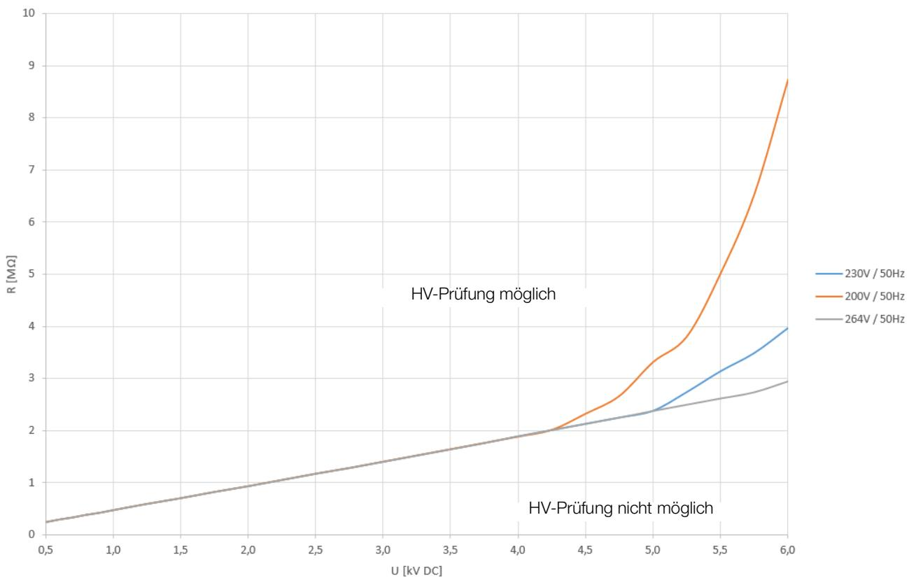
Typische maximale Belastung der HV-Quelle in Abhängigkeit von der Versorgungsspannung bei 60 Hz
